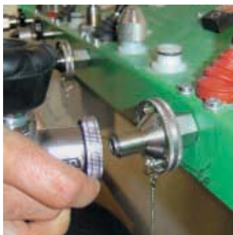
alphaCLICK raccordo per sostituzione rapida della bombola
